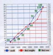
I consumi indicati nel grafico sono ricavati dalle curve di consumo del motore fornite dal costruttore, ma il consumo reale in mare potrà discostarsi dai dati pubblicati in funzione del carico imbarcato e della sua posizione, delle condizioni di uso dell'unità, della messa a punto e dello stato dei motori stessi, oltre che dalle caratteristiche delle eliche utilizzate.
